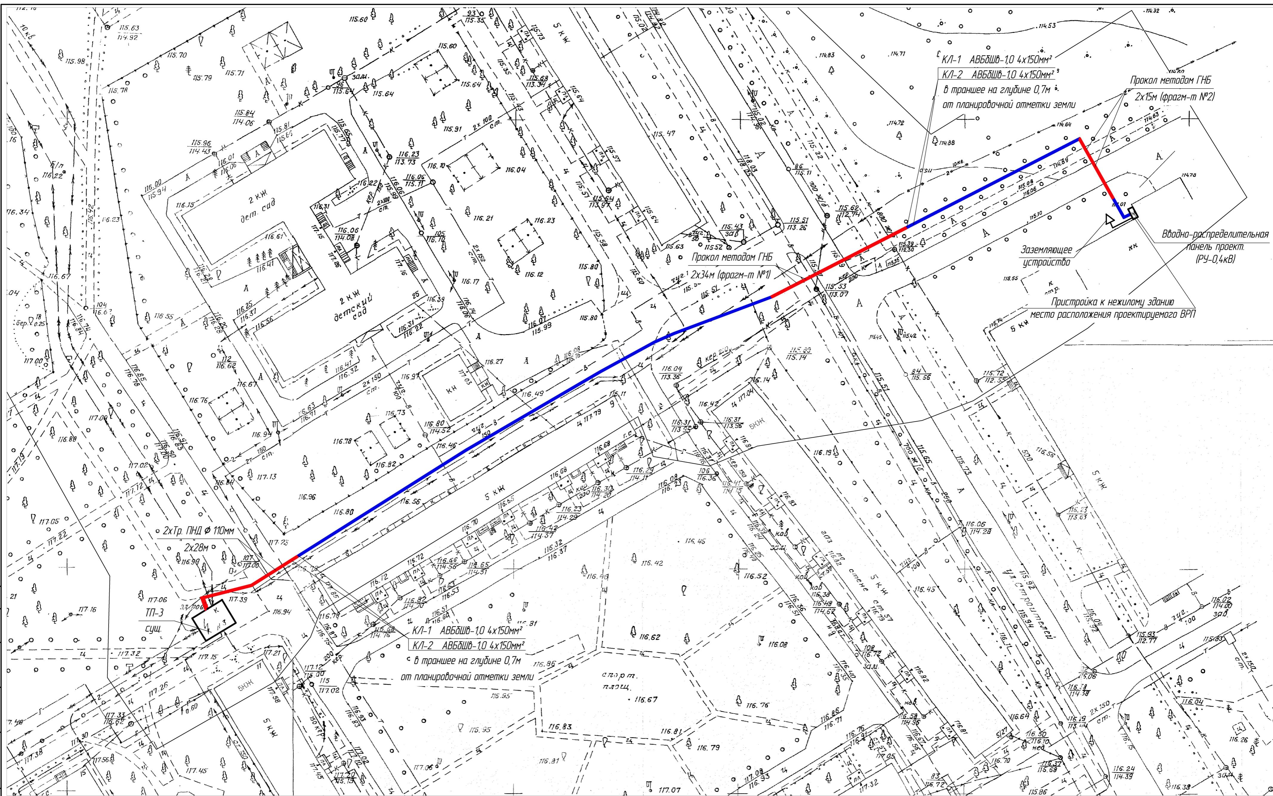
Ведомость прокладки кабеля и сооружения траншеи
